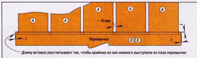
Рис. 2. Расположение планок А со вставками на перемычке.
