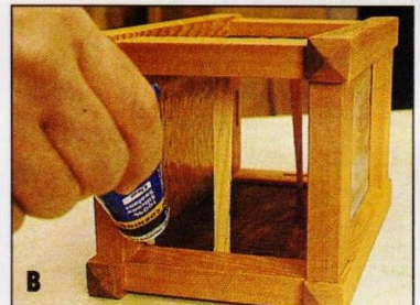
Две тонкие пружинящие планочки удерживают каждое стекло на месте при нанесении силиконового герметика.
