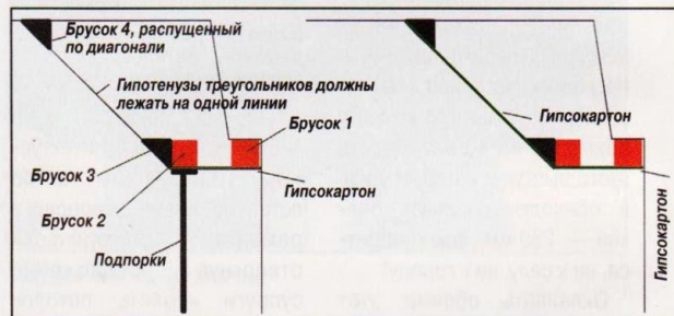
Рис. 4, 5. Монтаж короба со скошенной передней гранью.
